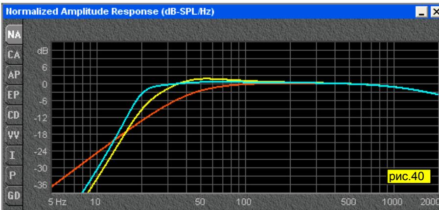
Как видно частотка значительно улучшилась - стала ровнее, а на частоте 20Гц завал только 3дБ. Частотка вроде бы нас устраивает, но посмотрим другие графики. На *рис.41*
