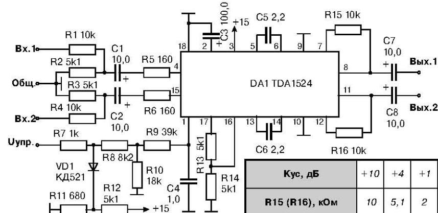
частоте 30 Гц завал АЧХ не превышает 0,3 дБ. На вывод регулировки баланса (16) подано половинное напряжение с внутреннего стабилизатора DA1 (17).
